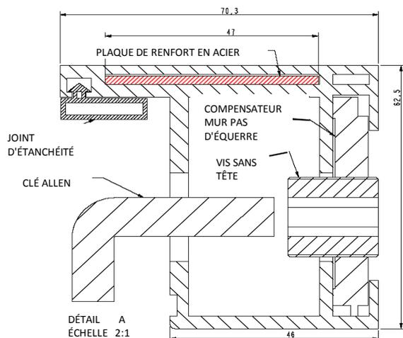
◀ Ce profilé permet la pose de la porte sans précadre, car la porte peut être installée directement sur le profilé. Les composants caractéristiques de cette typologie de pose sont une plaque de renfort en acier et des éléments de fixation qui servent à compenser si le mur n'est pas d'équerre.
